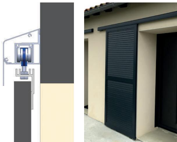
C - Rail en aluminium et bandeau en bois, fixation façade (uniquement pour le volet bois coulissant à cadre) hors motorisation
